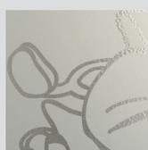
Procédé de dépolissage et de gravure du verre obtenu par projection puissante de sable suivant un modèle de pochoir. Il convient à tous les styles, modernes ou traditionnels.
